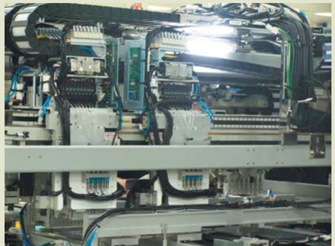
リニアモーターが装着されたテストハンドラー装備の内部
